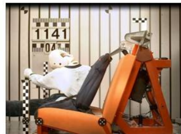
Рис 4с. Время 80 мсек. Начало подныривания. Нижняя часть ремня недопустимо проникает в область живота
