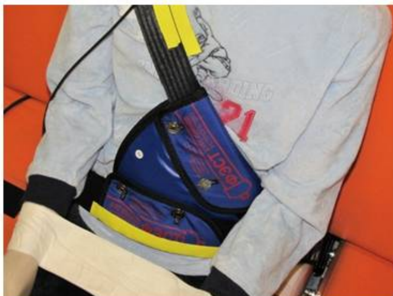
Рис 1. Тест с использованием накладки на ремень вместе с манекеном P10.
