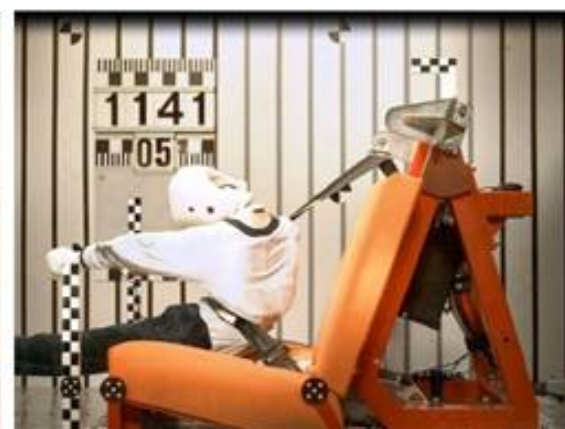
Рис 2в. Время 91 мсек. Началось подныривание, нижняя часть ремня недопустимо вошла в нижнюю часть живота.
